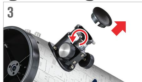
Entfernen Sie als Nächstes die Okularkappe und setzen Sie das 20 mm Okular in das Okularrohr ein. Wenn nötig, drehen Sie die Flügelschrauben heraus, damit die Gewinde das Einsetzen des Okulars nicht behindern.
