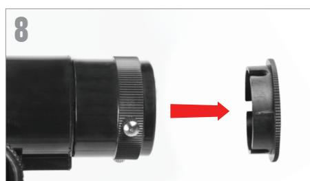
Retirez le capuchon de l'extrémité du système de mise au point du tube du télescope et assurez-vous que les deux vis à oreilles ne dépassent pas dans l'ouverture.
