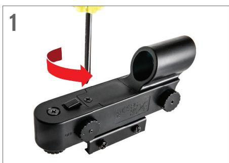
Usando un destornillador con cabezal Phillips, afloje el tornillo de la cubierta de la batería y abra la tapa.
