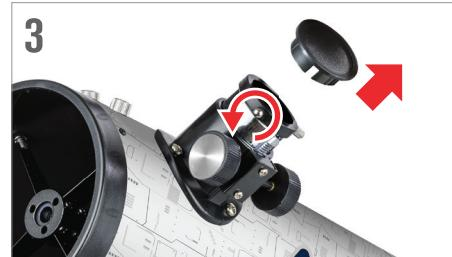
Ensuite, retirez le capuchon de l'oculaire et insérez l'oculaire de 20 mm dans le tube de l'oculaire. Si nécessaire, dévissez les vis à oreilles pour que les filetages ne gênent pas l'insertion de l'oculaire.
