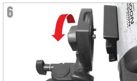
Far corrispondere il perno filettato da 1/4"-20 della piattaforma di montaggio con il foro filettato da 1/4"-20 sul fondo del tubo del telescopio e avvitare i due elementi ruotando la manopola di montaggio superiore in senso orario. Il serraggio deve essere stretto, ma non eccessivo.
