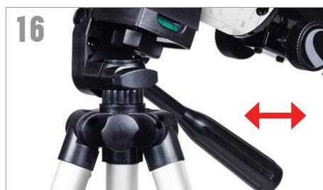
Per muovere il telescopio a sinistra e destra, mantenere una gamba del treppiedi con una mano mentre con l'altra si usare la manopola di panoramica per spostare il telescopio. La vite di blocco dell'azimut può essere allentata o serrata per regolare la tensione secondo le proprie preferenze.
