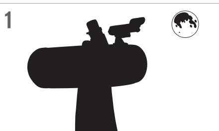
Quando la Luna è visibile in cielo predisporre il telescopio con installato l'oculare da 20 mm.
