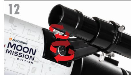
Nehmen Sie das Sucherfernrohr und entfernen die Kunststoffkappen an beiden Seiten der Linse. Richten Sie das Sucherfernrohr so aus, dass die größere Linse wie gezeigt zur Vorderseite des Tubus zeigt. Setzen Sie das Sucherfernrohr über die Gewindestangen am Tubus und ziehen es mit den Rändelmuttern fest.
