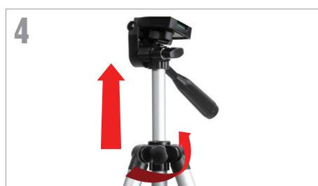
Um die Mittelsäule des Stativs auszuziehen, lösen Sie den Ring an der Montierung, indem Sie den Feststellknopf gegen den Uhrzeigersinn drehen und den Stativkopf anheben, bis er die gewünschte Höhe erreicht hat, drehen Sie dann den Feststellknopf im Uhrzeigersinn, um ihn festzuziehen.
