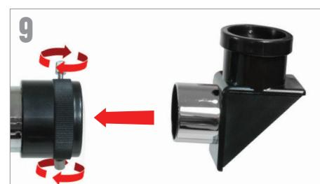
Trouvez le renvoi coudé dans la boîte et retirez les capuchons de plastique. Insérez le bâillet de la diagonale dans la porte-oculaire et fixez-la en place en serrant les vis à main.
