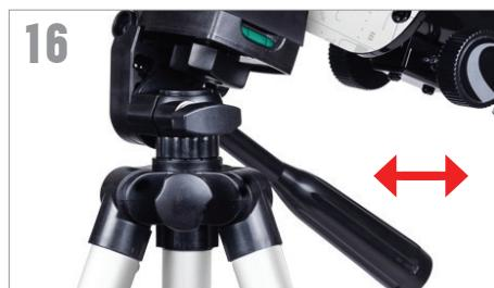
Um das Teleskop nach rechts und links zu bewegen, halten Sie mit einer Hand ein Stativbein fest, während Sie mit der anderen Hand den Schwenkgriff nehmen, um das Teleskop zu bewegen. Die Azimut-Stellschraube kann gelöst oder festgezogen werden, um die Spannung nach Belieben anzupassen.
