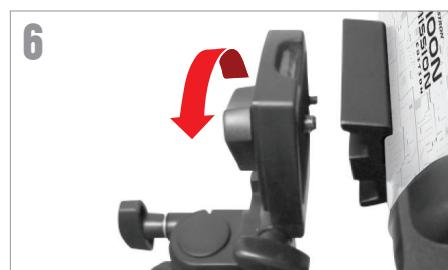
Haga coincidir el perno estriado de 1/4"-20 en la plataforma de montaje con el agujero estriado de 1/4"-20 de la parte inferior del tubo del telescopio y enrósquelo juntos girando el mando del soporte superior en sentido de las agujas del reloj. Debería estar apretado, pero asegúrese de no apretarlo en exceso.
