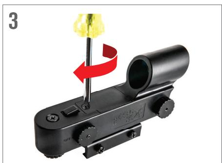
Setzen Sie die Abdeckung wieder auf das Sucherfernrohr und ziehen die Schraube mit dem Kreuzschlitzschraubendreher wieder fest.
