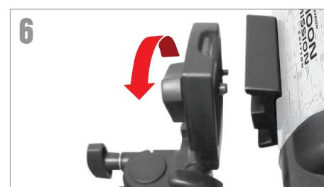
Faites correspondre le boulon fileté de 1/4"-20 de la plate-forme de montage au trou fileté de 1/4"-20 sur le dessous du tube du télescope et vissez-les ensemble en faisant tourner la molette du dessus de la monture dans le sens horaire. Cette molette doit être serrée, mais pas excessivement.
