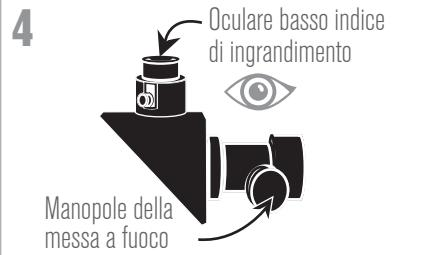
Guardare attraverso l'oculare da 20 mm del telescopio. Ruotare con cura le manopole di messa a fuoco per regolare la nitidezza dell'immagine.
