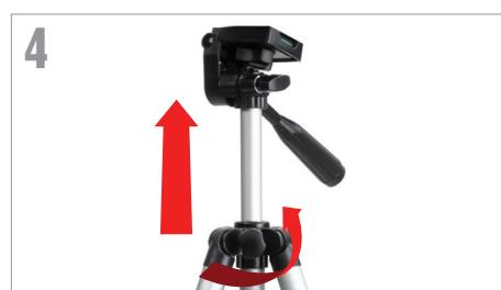
Pour allonger la colonne centrale du trépied, faites desserrer le collier de la monture en faisant tourner la molette de verrouillage dans le sens antihoraire, soulevez la tête du trépied jusqu'à ce qu'elle soit à la hauteur désirée et tournez le bouton de verrouillage dans le sens horaire pour la fixer.
