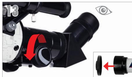
Nehmen Sie den Objektivdeckel vorne am Teleskop ab. Schauen Sie zum Beobachten wie gezeigt durch das Okular. Stellen Sie das Bild scharf, indem Sie an den Knöpfen unterhalb des Okularauszugs drehen.
