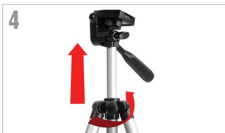
Per estendere il montante centrale del treppiedi, allentare il collare dell'attacco ruotando la manopola di blocco in senso antiorario, sollevare la testa del treppiedi fino all'altezza desiderata e ruotare la manopola di blocco in senso orario per assicurare.
