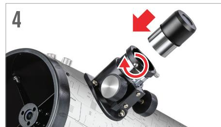
Une fois l'oculaire correctement installé, serrez les vis à oreilles pour le fixer.
