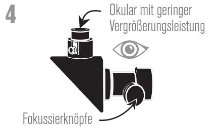
Schauen Sie jetzt durch das 20-mm-Okular des Teleskops. Drehen Sie die Fokussierknöpfe langsam, um das Bild scharfzustellen.
