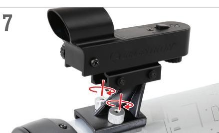
Setzen Sie das Sucherfernrohr über den Gewindestiften am optischen Tubus und fixieren das Sucherfernrohr, indem Sie die Rändelmuttern aus Schritt 5 festziehen.
