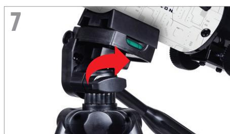
Drehen Sie die Montierung, bis sie waagerecht ist und ziehen den Knopf fest, um sie zu sichern.
