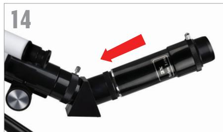
Für eine zusätzliche Vergrößerung können Sie die mitgelieferte 3-fach Barlowlinse verwenden. Setzen Sie die Barlowlinse zwischen dem Diagonalspiegel und dem Okular ein.
