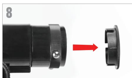
Entfernen Sie die Kappe an einem Ende des Okularauszugs am Tubus und vergewissern Sie sich, dass die beiden Stellschrauben nicht in die Öffnung ragen.
