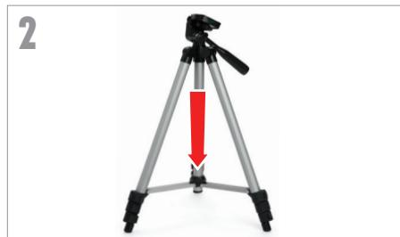
Um das Stativ aufzustellen, spreizen Sie die Beine nach außen, bis sie vollständig ausgezogen sind, drücken Sie dann die mittlere Beinstrebe nach unten.
