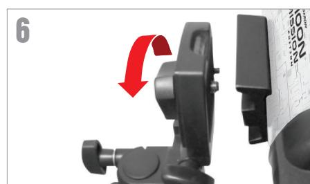
Setzen Sie den 1/4-Zoll-20-Gewindebolzen in der Montageplattform in das 1/4-Zoll-20-Gewindeloch an der Unterseite des Tubus ein und schrauben beides zusammen, indem Sie den oberen Knopf der Montierung im Uhrzeigersinn drehen. Dies sollte festgezogen sein, aber nicht zu fest anziehen.
