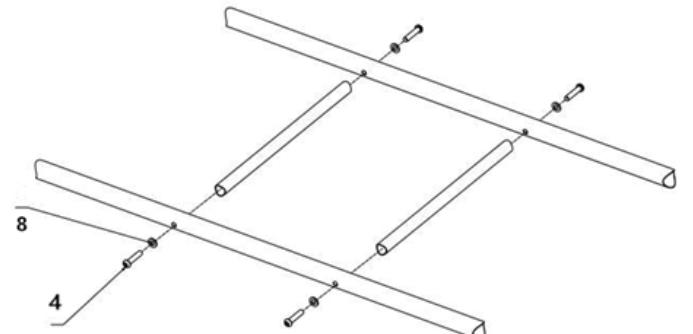
Verbinden Sie die Stangen mit Schrauben #4 (4 Stück) und Unterlegscheiben #8 (4 Stück).
