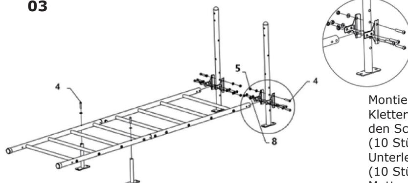
Montieren Sie die Kletterrahmen mit den Schrauben #4 (10 Stück), den Unterlegscheiben #8 (10 Stück) und den Muttern #5 (8 Stück).
