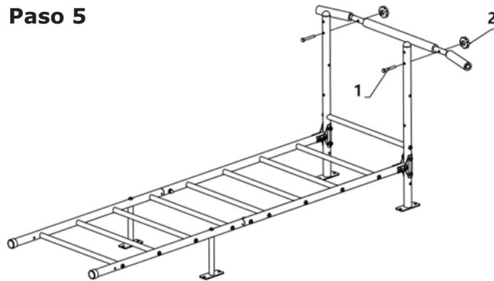
Instale la barra de tracción al conjunto con 2 tornillos (#1) y 2 perillas (#2).
