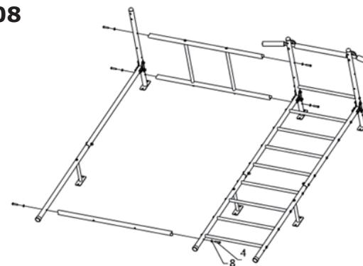
Verbinden Sie die Stangen mit Schrauben #4 (6 Stück) und Unterlegscheiben #8 (6 Stück).
