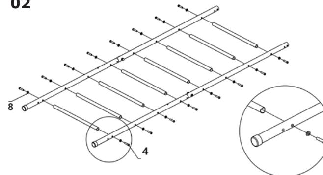
Befestigen Sie die horizontalen Stangen an den vertikalen Stangen mit den Schrauben #4 (16 Stück) und den Unterlegscheiben #8 (16 Stück).
