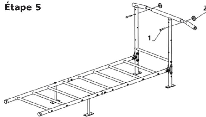
Installez la barre de traction sur le SET avec les vis n°1 (2 pièces) et les boutons n°2 (2 pièces).
