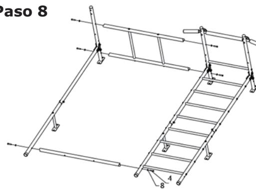
Conecte las barras con 6 tornillos (#4) y 6 arandelas (#8).
