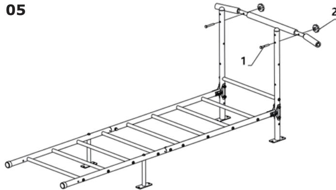
Befestigen Sie die Klimmzugstange mit den Schrauben # 1 (2 Stück) und den Knöpfen # 2 (2 Stück) am Klettergerüst.
