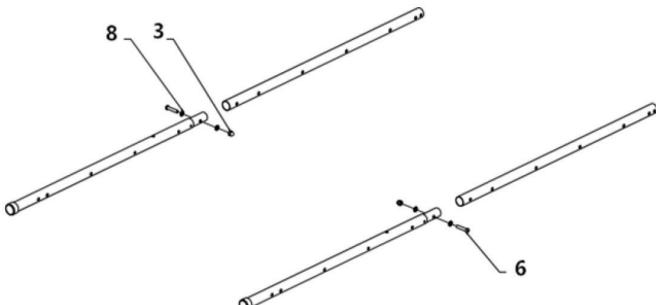
Połącz pionowe pręty za pomocą 2 śrub (6), 4 podkładek (8) i 2 nakrętek (3).
