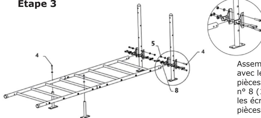
Assemblez le JEU avec les vis n° 4 (10 pièces), les rondelles n° 8 (10 pièces) et les écrous n° 5 (8 pièces).
