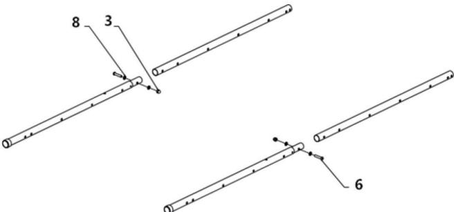
Conecte las barras verticales con 2 tornillos (#6), 4 arandelas (#8) y 2 tuercas (#3).
