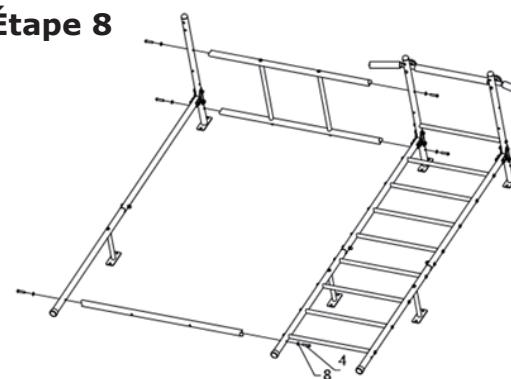
Connectez les barres avec des vis n°4 (6 pièces) et des rondelles n°8 (6 pièces).
