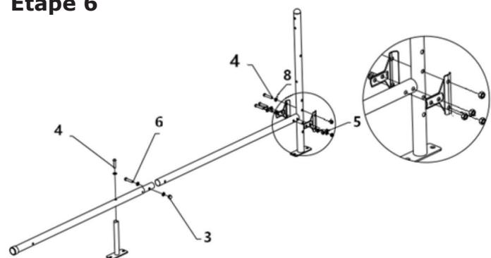
Connectez les barres avec la vis n° 6 (1 pièce), les rondelles n° 8 (7 pièces), les écrous n° 5 (4 pièces), les vis n° 4 (5 pièces) et l'écrou n° 3 (1 pièce).
