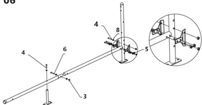
Verbinden Sie die Stangen mit der Schraube #6 (1 Stück), den Unterlegscheiben #8 (7 Stück), den Muttern #5 (4 Stück), den Schrauben #4 (5 Stück) und der Mutter #3 (1 Stück).
