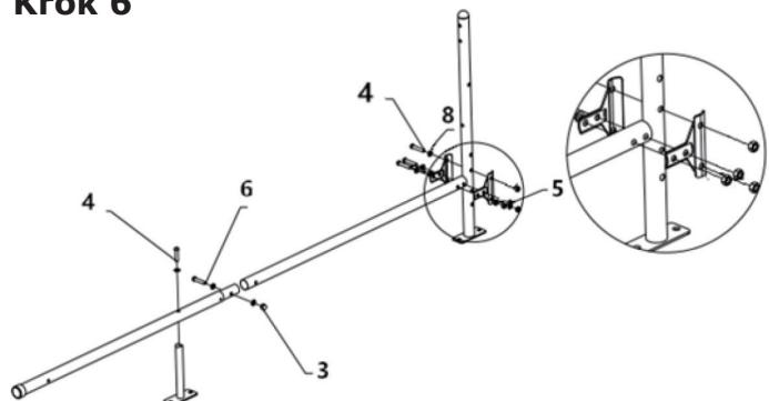
Za pomocą 1 śruby (6), 7 podkładek (8), 4 nakrętek (5), 5 śrub (4) i 1 nakrętki (3) połącz pręty stelażu siatki wspinaczkowej.
