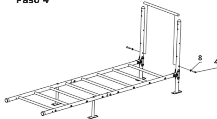
Conecte las barras horizontales al conjunto con 2 tornillos (#4) y 2 arandelas (#8).
