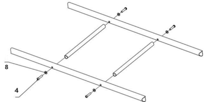
Conecte las barras con 4 tornillos (#4) y 4 arandelas (#8).
