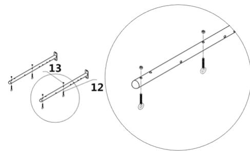
Zamocuj 3 śruby oczkowe (12) i 3 nakrętki (13) na górnego wspornikach, tak jak pokazano na rysunku.
