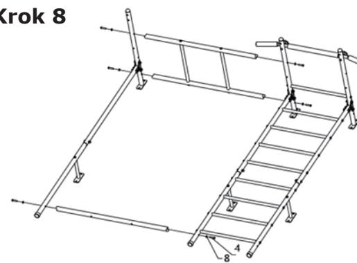
Za pomocą 6 śrub (4) i 6 podkładek (8) połącz stelaż siatki wspinaczkowej i górną drabinkę z pionową drabinką gimnastyczną.
