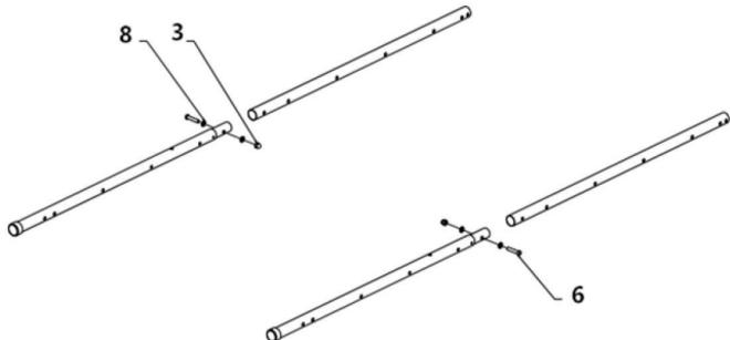
Connectez les barres verticales avec des vis n°6 (2 pièces), des rondelles n°8 (4 pièces) et des écrous n°3 (2 pièces).
