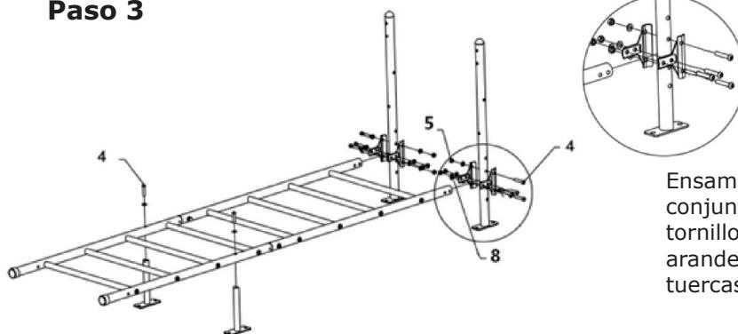
Ensamble el conjunto con 10 tornillos (#4), 10 arandelas (#8) y 8 tuercas (#5).
