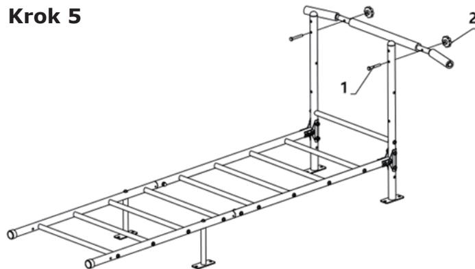
Za pomocą 2 śrub (1) i 2 pokręteł (2) przymocuj drążek do podciągania do górnego wspornika drabinki.
