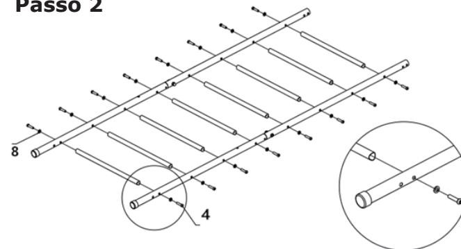
Installare le barre orizzontali sulle barre verticali con le viti #4(16pcs) e le rondelle #8(16pcs).
