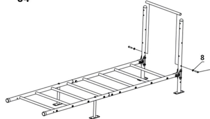
Verbinden Sie die horizontale Stange mit den Klettergerüsten mit den Schrauben #4 (2 Stück) und den Unterlegscheiben #8 (2 Stück).
