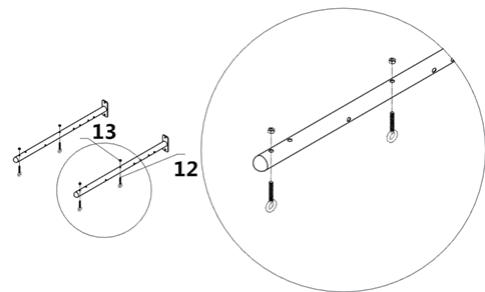
Instale 3 tornillos (#12) y 3 tuercas (#13) en la barra, como se muestra en la imagen.
