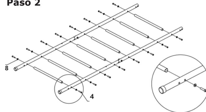
Instale las barras horizontales a las verticales con 16 tornillos (#4) y 16 arandelas (#8).
