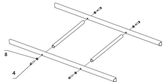
Connectez les barres avec des vis n°4 (4 pièces) et des rondelles n°8 (4 pièces).
