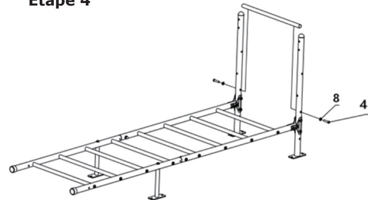
Connectez la barre horizontale au JEU avec des vis n°4 (2 pièces) et des rondelles n°8 (2 pièces).
