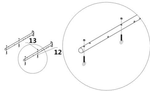
Montieren Sie die Schraube #12 (3 Stück) und die Mutter #13 (3 Stück) an der Stange, wie oben abgebildet.
