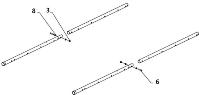
Verbinden Sie die vertikalen Stangen mit den Schrauben #6 (2 Stück), Unterlegscheiben #8 (4 Stück) und Muttern #3 (2 Stück).
