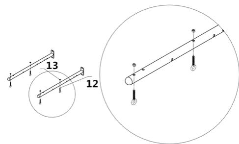
Installez la vis n°12 (3 pièces) et les écrous n°13 (3 pièces) sur la barre, comme illustré ci-dessus.
