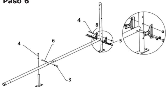
Conecte las barras con 1 tornillo (#6), 7 arandelas (#8), 4 tuercas (#5), 5 tornillos (#4) y 1 tuerca (#3).
