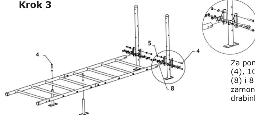
Za pomocą 10 śrub (4), 10 podkładek (8) i 8 nakrętek (5) zamontuj wsporniki drabinki.
