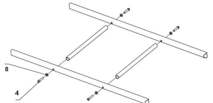
Za pomocą 4 śrub (4) i 4 podkładek (8) połącz pręty górnej drabinki.
