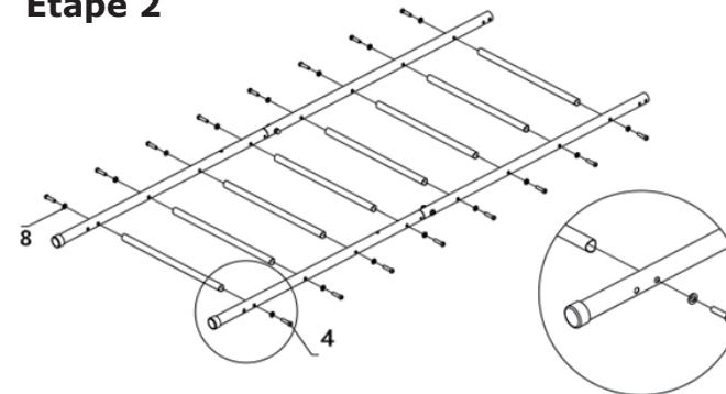
Installez les barres horizontales sur les barres verticales avec des vis n° 4 (16 pièces) et des rondelles n° 8 (16 pièces).
