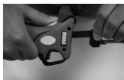
7. UNE FOIS INSTALLÉ, LE LEVIER DE DÉGAGEMENT DE LA LAME DOIT RESTER DANS LA POSITION LA PLUS EN AVANT DU MANCHE.
